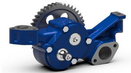
**Besonderheit:** Diese Pumpe eignet sich zum Einbau in Ölwanne. Besonders ist die Pumpenbefestigung mit integriertem Kanal und der zusätzliche Abtrieb mit Zahnwellenprofil.
